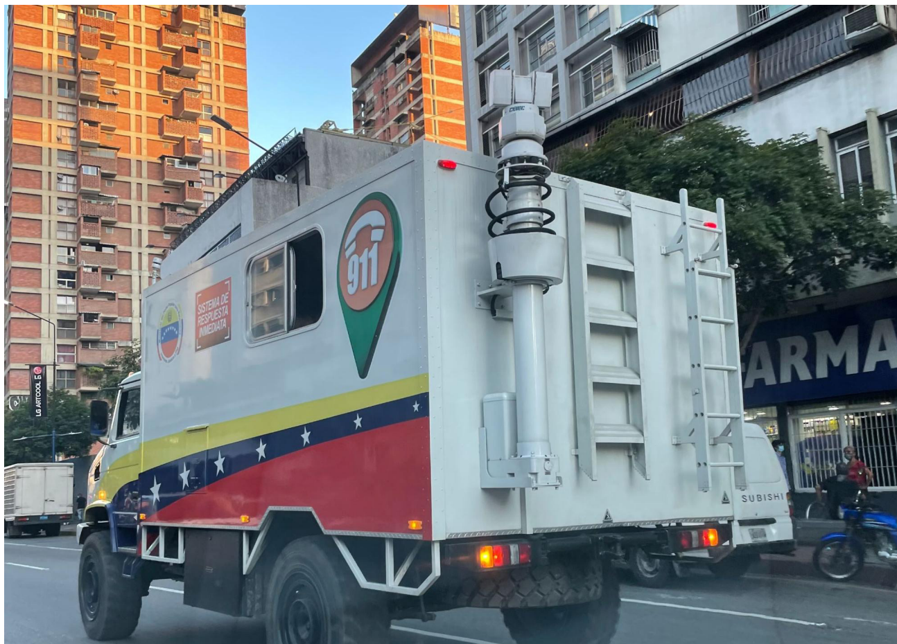
Unidad de mando móvil con sistema multicámara CEIEC sobre mástil desplegable. (Fuente:VEsinFiltro)
